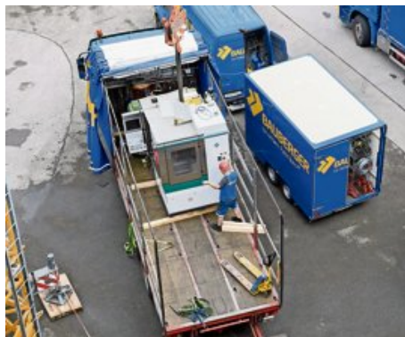
Die schweren Maschinen müssen zunächst transportfertig gemacht werden, bevor sie von einem Kran durch ein Loch im Dach in die Luft gehievt und auf einen Umzugswagen geladen werden.
